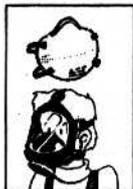
Le particelle presenti nell'aria sono trattenute dal filtro mediante un'azione meccanica ed elettrostatica.
