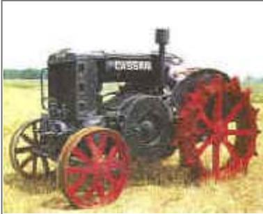
**Fig 6** : 1927 : **il primo prototipo della Cassani** (che diventerà la Same nel 1942) , con un grosso motore Diesel bicilindrico da 12,7 litri **Francesco Cassani** aveva capito per primo in Italia e forse nel mondo , che il futuro dei trattori era nel dotarli di motori Diesel e non più a vapore , a gas o a Benzina o a Petrolio o monocilindrici a testa calda . **Raro nelle mostre di trattori d' epoca** . (Da Baldwin - Morland 1999) .
