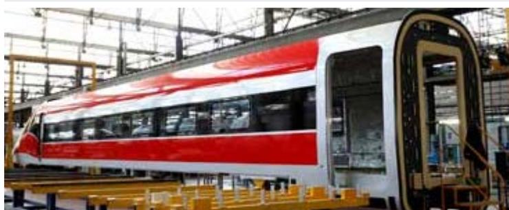
Frecciarossa 1000 sarà un treno bidirezionale a trazione multitemperatura di nuova generazione. A composizione bloccata e potenza distribuita, per sfruttare al meglio l'aderenza anche in
